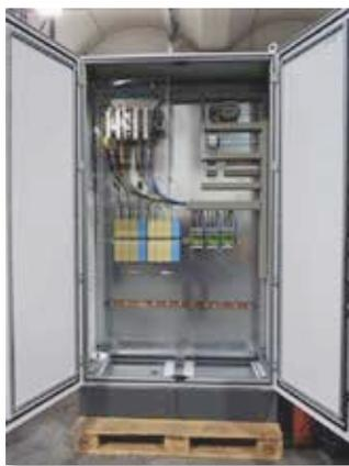
Bei der Wahl der Größe der automatischen Lastumschaltung (ATS) ist meist die Absicherung der Hauptzuleitung entscheidend. Denn das Schaltvermögen der ATS bemisst sich nach dem max. anliegenden Nennstrom, der geschaltet werden muss. Unsere Lastumschaltungen sind allpolig (4-polig) ausgeführt und sind mit einem Schaltvermögen bis zu 4000 A Niederspannung erhältlich.
